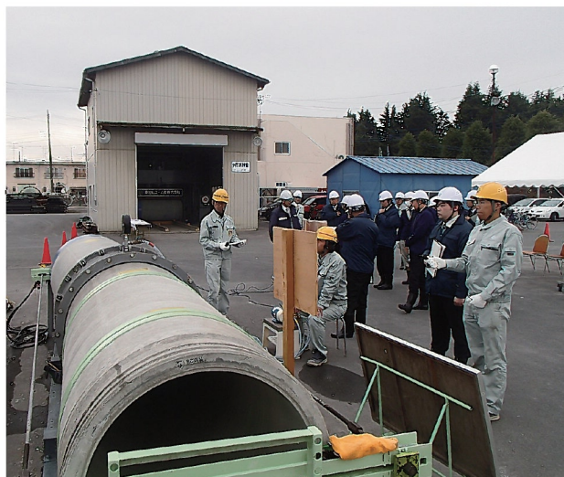
最大拔出し長確認状況
