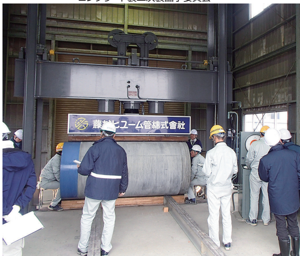
外圧試験によりJSWAS A-2-2018に規定した外圧強度3種に適合した推進管であることが確認されました。
