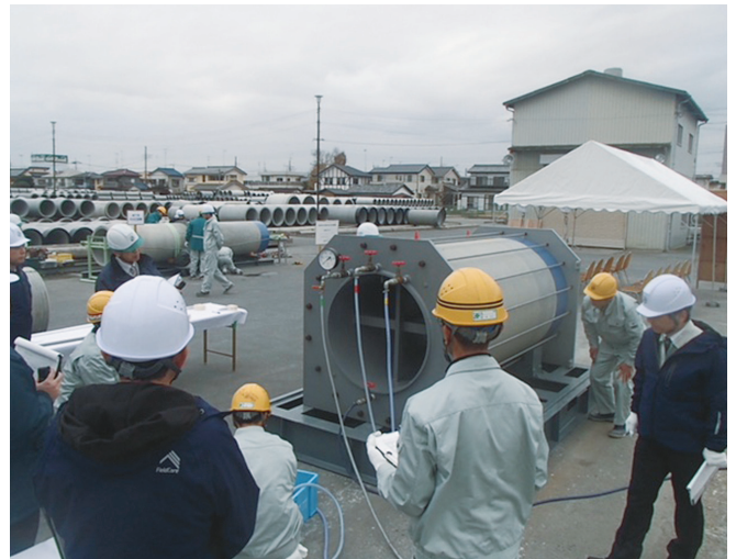
内圧試験によりJSWAS A-2-2018に規定した内圧強さAW6(0.6MPa)に適合した推進管であることが確認されました。
