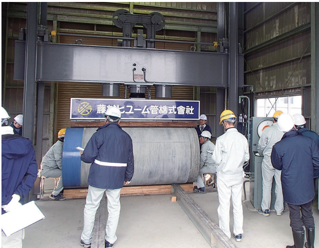
外圧試験によりJSWAS A-2-2018に規定した外圧強度3種に適合した推進管であることが確認されました。
