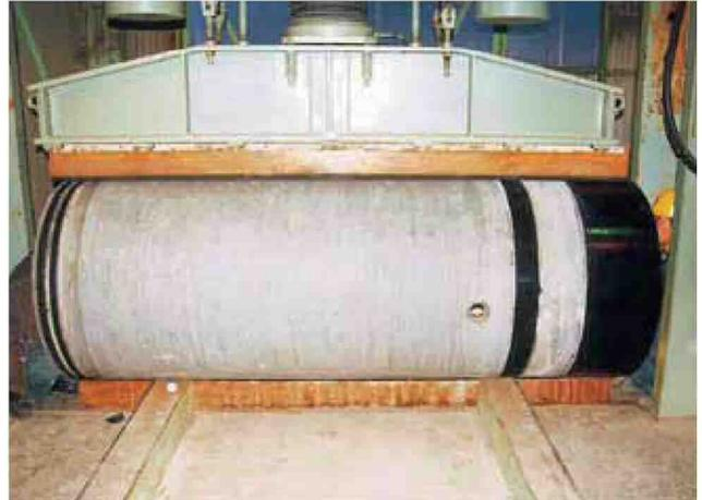
ひびわれ荷重、及び破壊荷重は、所定の規格荷重を上回りました。
