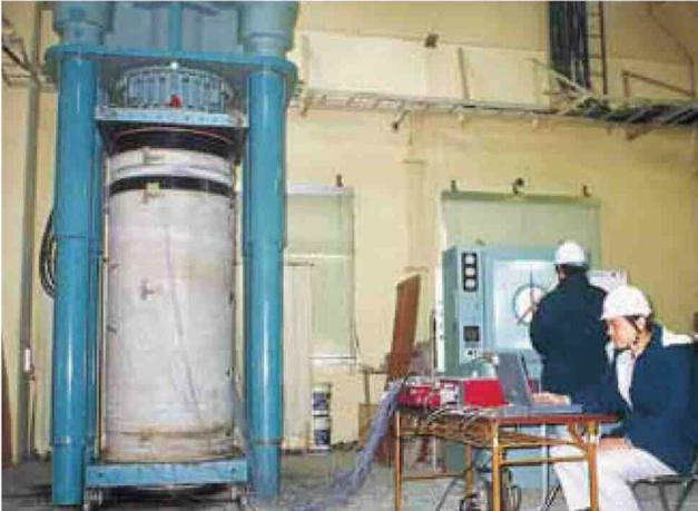
加圧時の滑材排出部周辺に生ずるひずみなどを調査し、所定の許容推進力を有していることが確認できました。
